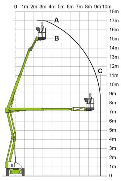
Hauteur de travail A: 17.20 m Hauteur de plancher B: 15.20 m Déport C: 9.40 m Hauteur sous déport : 7.00 m Charge admissible: 225 kg Poids à vide: 5000 kg Longueur repliée J: 6.35 m Longueur transport H: 4.80 m Largeur F: 2.00 m Hauteur repliée **D**: 2.10 m Bras pendulaire: 150°
