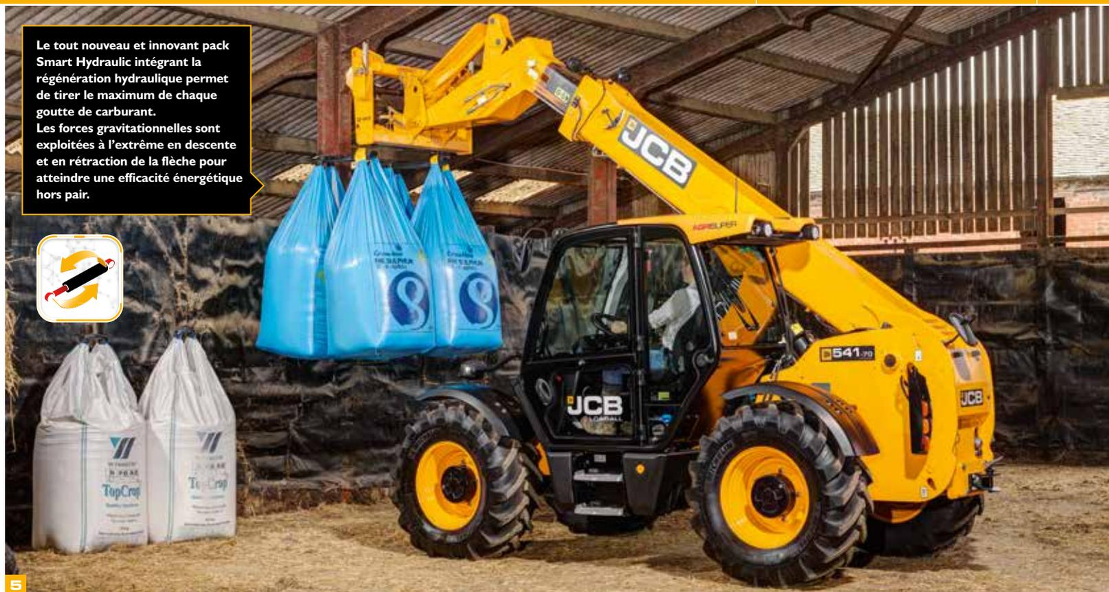
Le tout nouveau et innovant pack Smart Hydraulic intégrant la régénération hydraulique permet de tirer le maximum de chaque goutte de carburant. Les forces gravitationnelles sont exploitées à l'extrême en descente et en rétraction de la flèche pour atteindre une efficacité énergétique hors pair.
