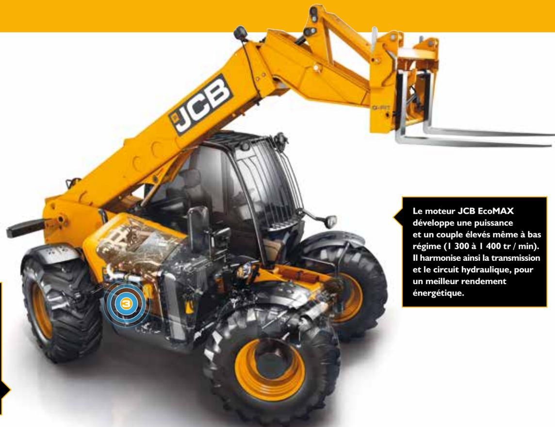
Le moteur JCB EcoMAX développe une puissance et un couple élevés même à bas régime (1 300 à 1 400 tr / min). Il harmonise ainsi la transmission et le circuit hydraulique, pour un meilleur rendement énergétique.
