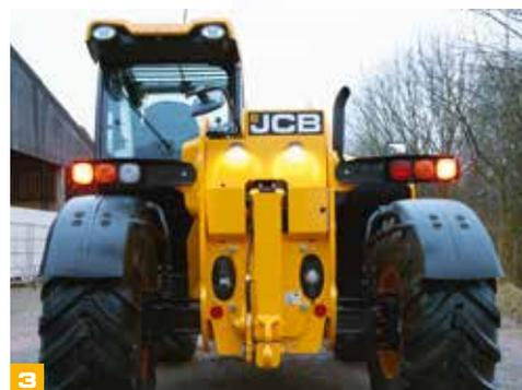
3 Les TELESCOPIC JCB AGRI d'une hauteur de levage de 7 m ou plus sont équipés d'origine de phares arrière escamotables pour une protection optimale contre les détériorations typiques pendant les tâches agricoles.
